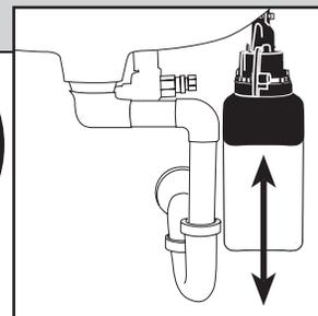
Correctement installé, le dispositif pend à la verticale sous l'évier.
